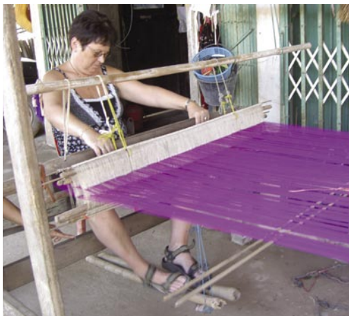
Jag väver silke. Borde tagit av mig sandalerna. Tramporna är två bambupinnar. Obs! Ingen slagbom, jag slår direkt med skeden.
