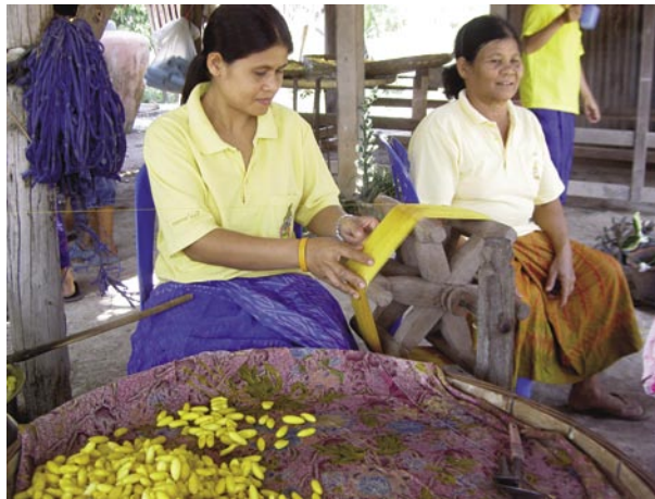
Här härvas silket upp direkt från ångbadet på en härvel, den här gången blir det tjock silke, kanske 100 kokonger åt gången. I förgrunden väntar nya kokonger på att bli doppade i ångbadet.
